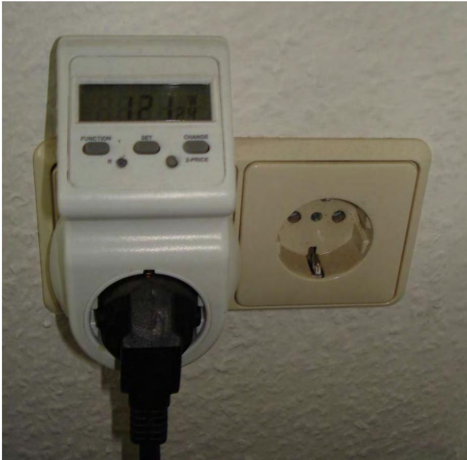
Bild 48: Messgerät für Energieverbrauch und Energiekosten (Quelle: eigene Fotos)
